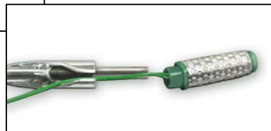
Sensor expulsado de la herramienta de inserción.
