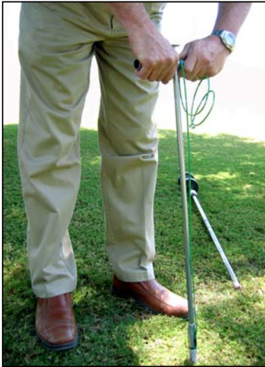
El sensor se coloca en el extremo de la herramienta de inserción #1017.
