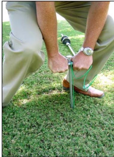
Use la agarradera T para "asentar" el sensor en el fondo del agujero, la profundidad máxima es de 76cm.
