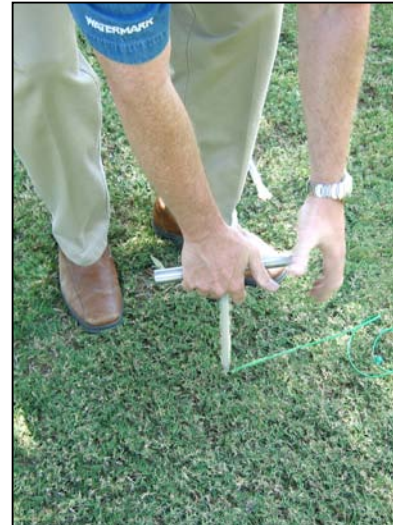
Desconecte la herramienta del sensor con el botón de expulsión.
