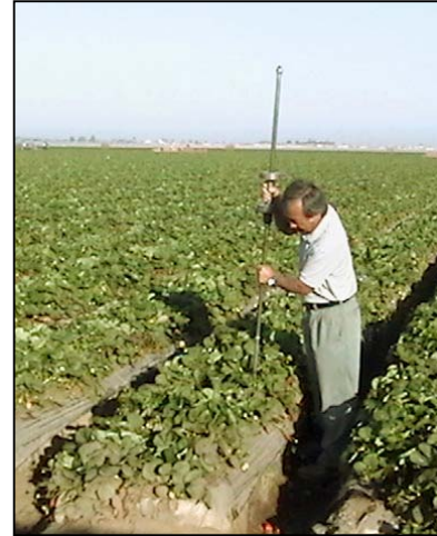
Instalaciones más profundas se hacen más fáciles con el martillo deslizante #1012.
