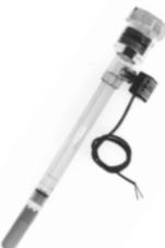
El modelo RSU: Este reemplaza el indicador de cualquier Irrometer convirtiendo la lectura a un 4-20 mA señal de corriente. Por ejemplo: SR-RSU 12". La calibración varía según el alcance de medidas del instrumento.
