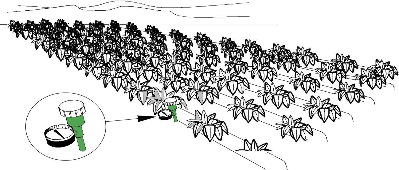
1. Instale los Irrrometers en una distancia de 3 o 4 plantas lejos del camino para evitar daño del tráfico
