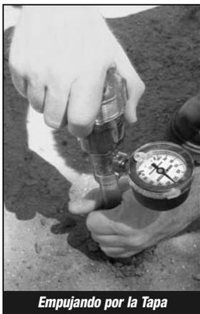
en dirección de las manecillas del reloj para evitar aflojar la punta. No es conveniente darle movimiento de vaivén ni de palanca para su desprendimiento, ya que esto puede provocar roturas en la unión de la punta de cerámica con el tubo.
